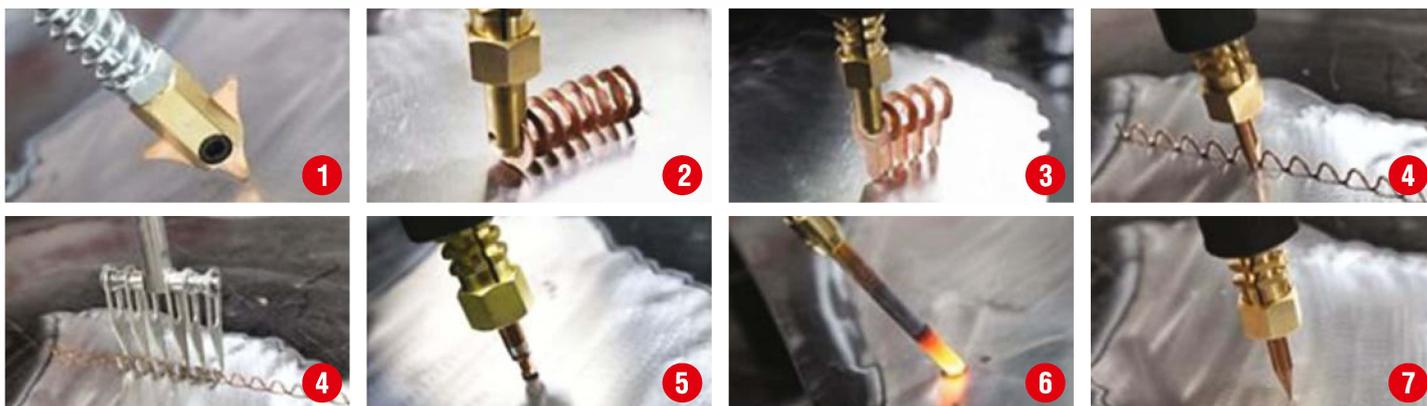
1 – Приварка треугольных звезд. 2 – Приварка круглых шайб. 3 – Приварка шайб с ножкой (формы ОТ). 4 – Приварка волнистой проволоки. 5 – Приварка шпилек. 6 – Нагрев угольным электродом. 7 – Односторонняя точечная сварка.
