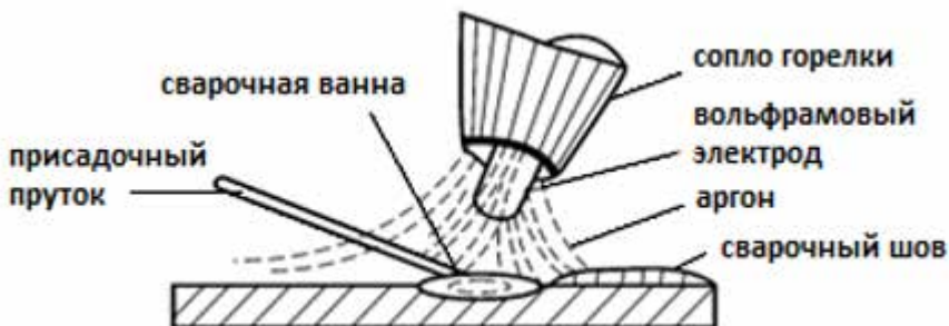
Рисунок 11 – Схематичное изображение процесса TIG сварки
